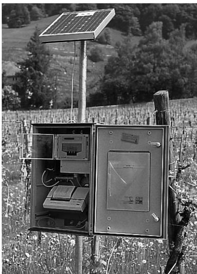
**Abb. 4: Warngerät und Kleinwetterstation Lufft HP-100 mit Solarstromversorgung, Zentraleinheit und Drucker.**
