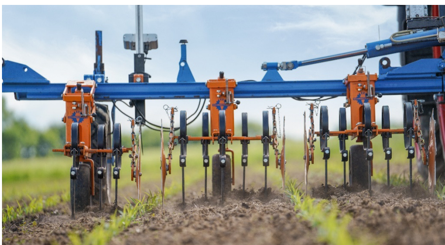
Digitale Technologien wie dieses kameragesteuerte Hackgerät ermöglichen eine Reduktion des Pflanzenschutzmitteleinsatzes. Foto: Amazone-Werke.
