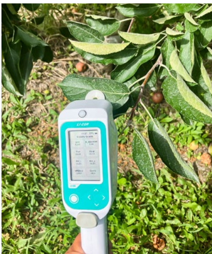
Einsatz des LiCor-600-Porometers an einem Apfelblatt im Sommer. (© Agroscope, Silvina Dayer)
