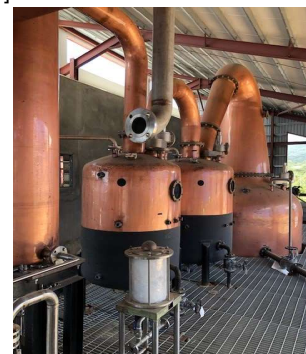
Abb. 3: Traditionelle Pot-Still Anlage in der Rum-Brennerei (Bildquelle: Pascal Kählin)
