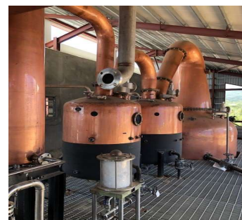
Fig. 3: Alambicco Pot-Still tradizionale in una distilleria di rum (Fonte: Pascal Kählin)
