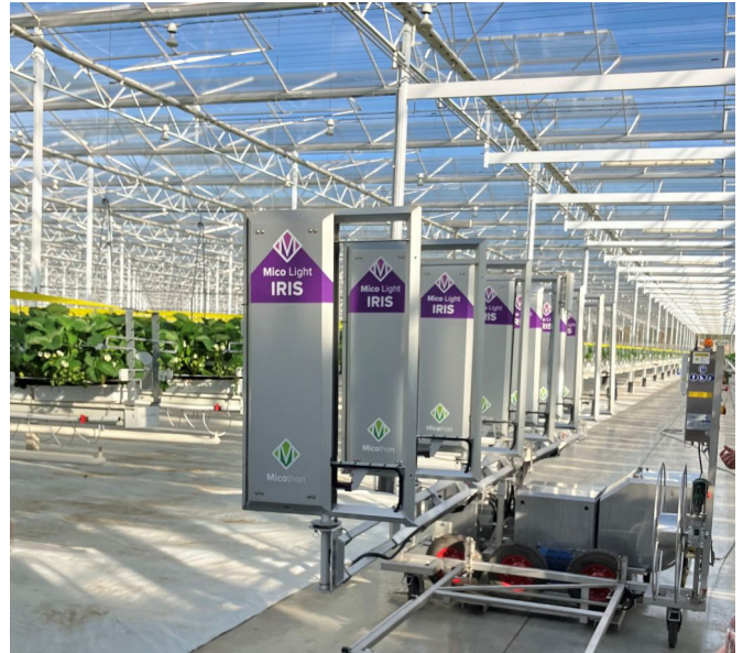
UV-C-Roboter für die Behandlung von sechs Reihen in einem Durchgang in einem Gewächshaus.
