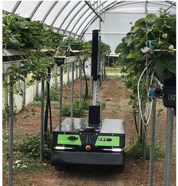
Geländegängiger UV-C-Roboter für den Einsatz in Stellagen im Tunnel.
