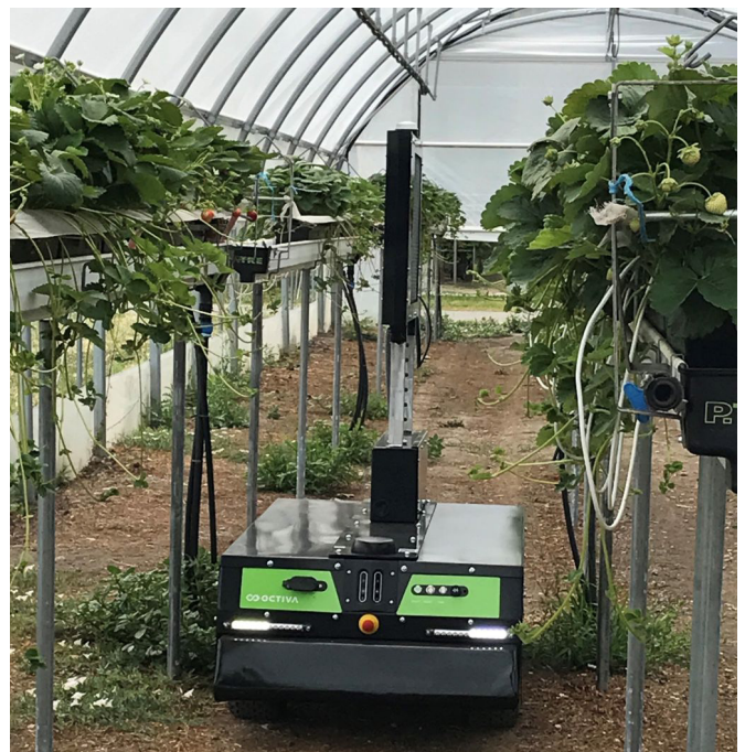
Robot UV-C tout-terrain destiné à une utilisation en tunnel sur des tables surélevées.
