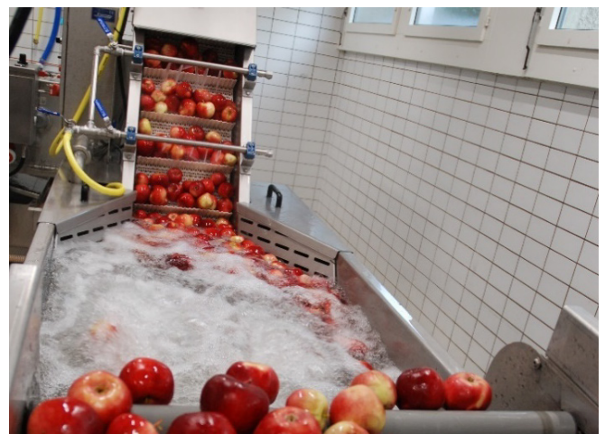
Abb. 2: Apfelpresse am Strickhof mit Reinigungsbad (Foto: Agroscope).
