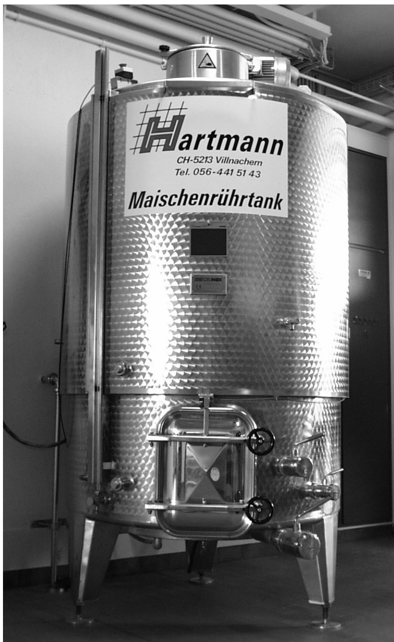
Abb. 1: Der Maischerührtank System Hartmann.
