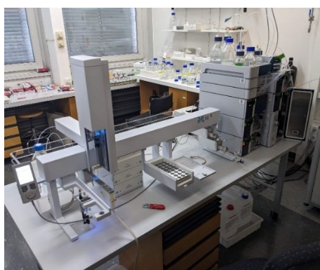
Abbildung 20: LC-MS/MS zur weiteren Analyse niedriger Tracerkonzentrationen (Quelle: Agroscope).
