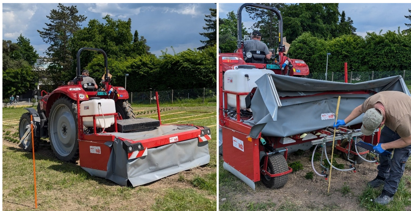
Abbildung 1: Stekete-Prototyp II auf einer Versuchsfläche in Wädenswil (ZH) 2025. (Quelle: Agroscope)
