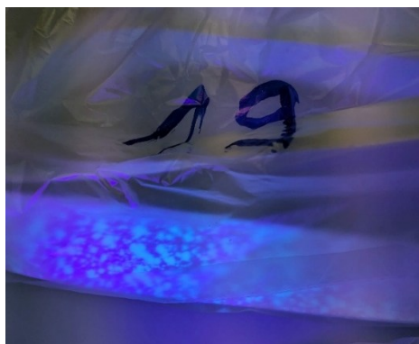
Abbildung 17: Optische Beurteilung der Driftproben unter Schwarzlicht (Quelle: Agroscope).
