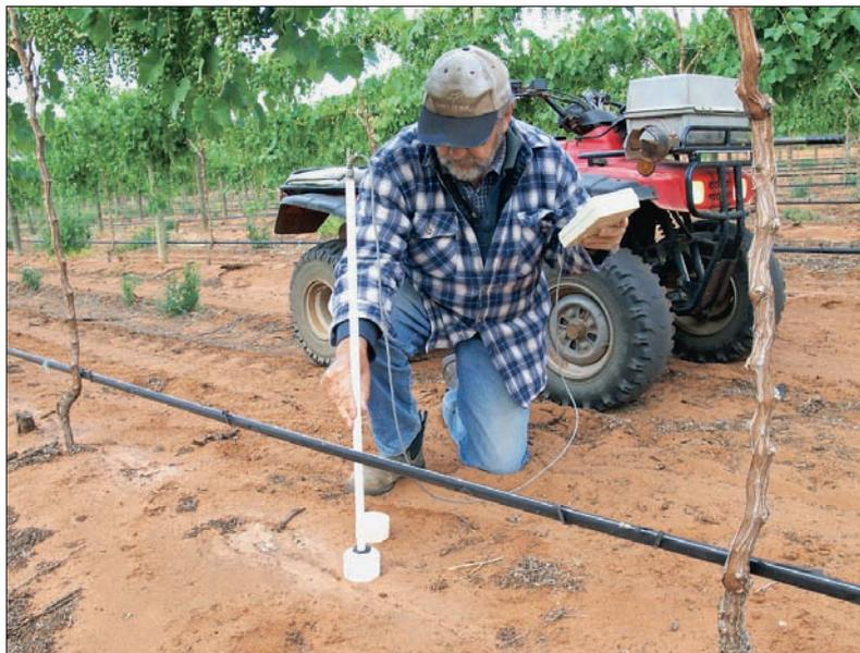
versen Privatfirmen aufzeigen, dass mit dem Einsatz von elektromagnetischen Bodenwassermessgeräten (Abb. 6), deren Daten laufend an einen Computer übermittelt werden, die Menge und der Zeitpunkt der Wassergaben optimiert werden können. Die Bewässerungsmengen werden durch professionelles Management von sechs bis sieben ML/ha auf unter fünf ML/ha gedrückt. Fachleute sind sich einig, dass der verbesserten Ausbildung der Landwirte beim Wassermanagement grosse Bedeutung zukommt.
