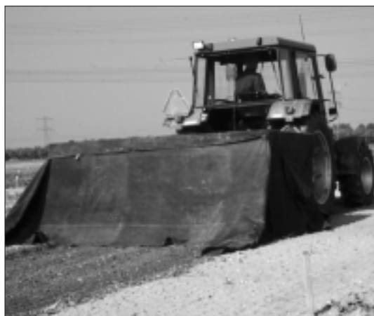
La couverture de la herse rotative avec du plastique imperméable à la lumière diminue la germination de nouveaux adventices lors de la préparation du lit de plants.
