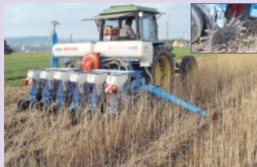
Fig. 17. Semis direct de betteraves sucrières dans du radis oléifère, déperri par le gel, avec un unique apport d'azote localisé. Les roues en étoiles montées devant les socs semeur écartent les débris de plantes.
