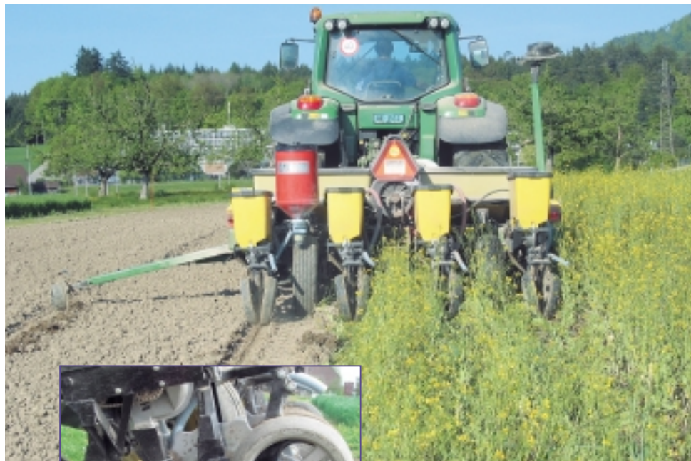
◁△ Fig. 8. Le même semoir (ici à soc «Cross Slot» pour le maïs) est utilisé pour obtenir des densités de plantes identiques dans les deux systèmes.
