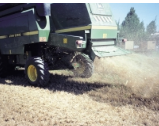
Fig. 10. Il est avantageux de disposer d'une moissonneuse-batteuse pourvue de répartiteurs aussi bien pour les balles que pour la paille. Les résidus de récolte sont ainsi bien répartis et ne forment pas d'andains inhibant la germination.
