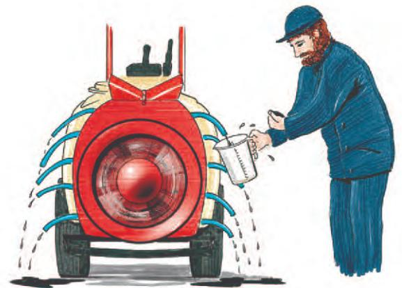
Berechnung: Durchfluss Einzeldüse l/min/Düse
