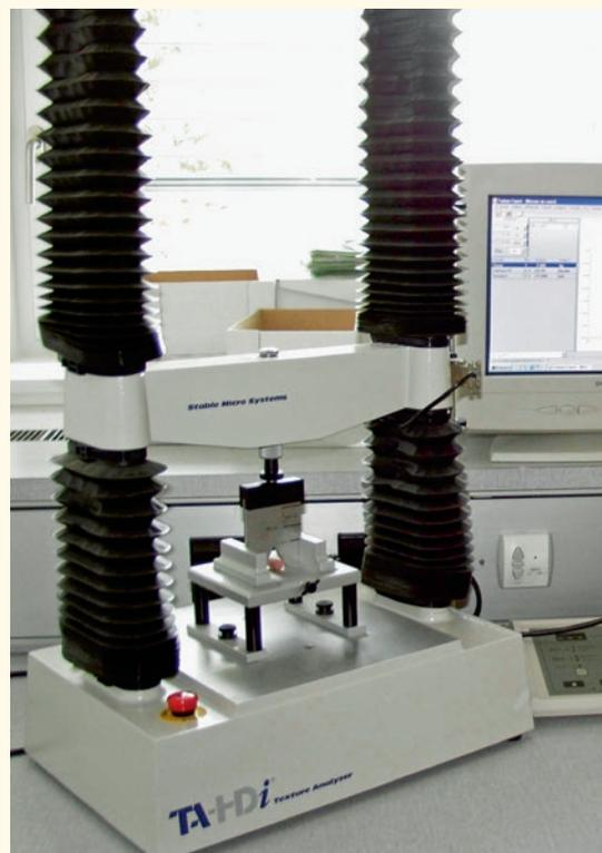
Abb. 1 | Gerät zur Scherkraftmessung. Zur Ermittlung eines Durchschnittswerts pro Tier erfolgen nach dem Kochen zehn Stanzungen.
