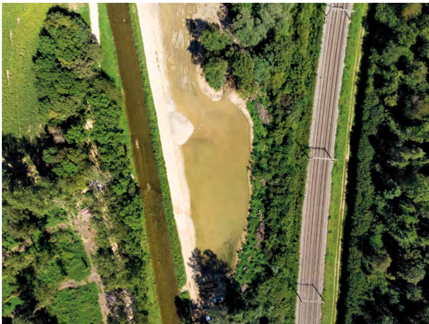
Abschnitt der Venoge (Kanton Waadt) am 4. September 2019. Zwischen Lussery-Villars und Penthalaz wird die Venoge renaturiert. Das neue Flussbett zwischen der Eisenbahnlinie und dem alten Kanal gibt dem Wasser mehr Platz. Davon profitieren sowohl die Biodiversität als auch der Hochwasserschutz. Bildquelle KEYSTONE / Laurent Gilliéron
