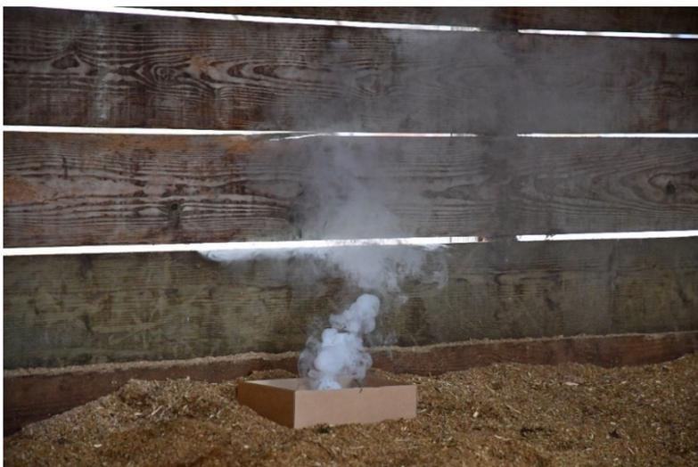
Links: Beispiel von Lüftungsschlitzen in Boxenwänden, welche die Luftzirkulation und damit den Abfluss von Schadgasen und Staub über der Einstreu aus den Boxen ermöglichen. Rechts: der durch die Lüftungsschlitzen entweichende Luftstrom wird hier durch Rauch sichtbar gemacht. | © Agroscope, SNG
