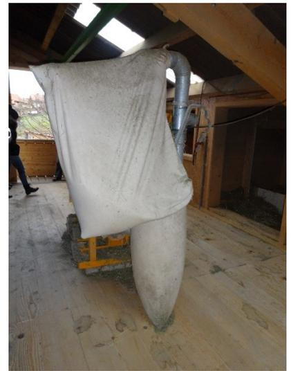
*Beispiel einer Heurüstmaschine. Das Heu wird in den Trog eingefüllt und durch ein Schüttelwerk gelockert. Staub und Erde fällt nach unten, und die wertvollen Pflanzenteile und Samen werden in den weissen Sack abgesaugt. | © Agroscope, SNG, C. Wyss*
