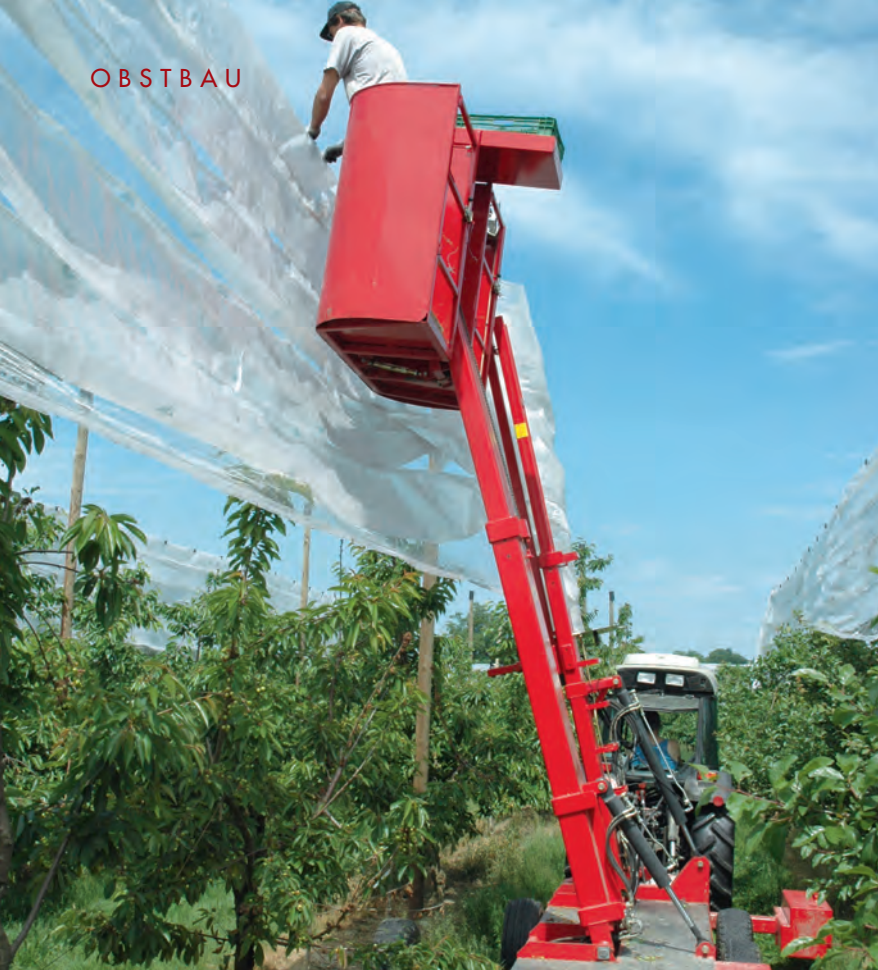
Abb. 2: Befestigung der Folie mit der Maschine Fruitwrap in einer Kirschanlage. Dieses Gerät könnte auch für die Montage einer Beschattung geeignet sein.
