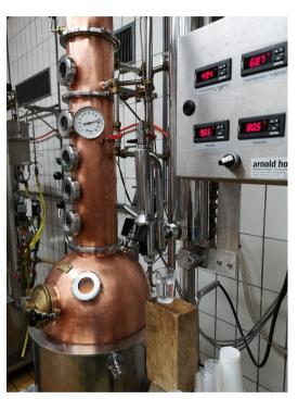
Standardisiertes Destillationsverfahren über die Geistrohrtemperatur um Sorten vergleichen zu können.
