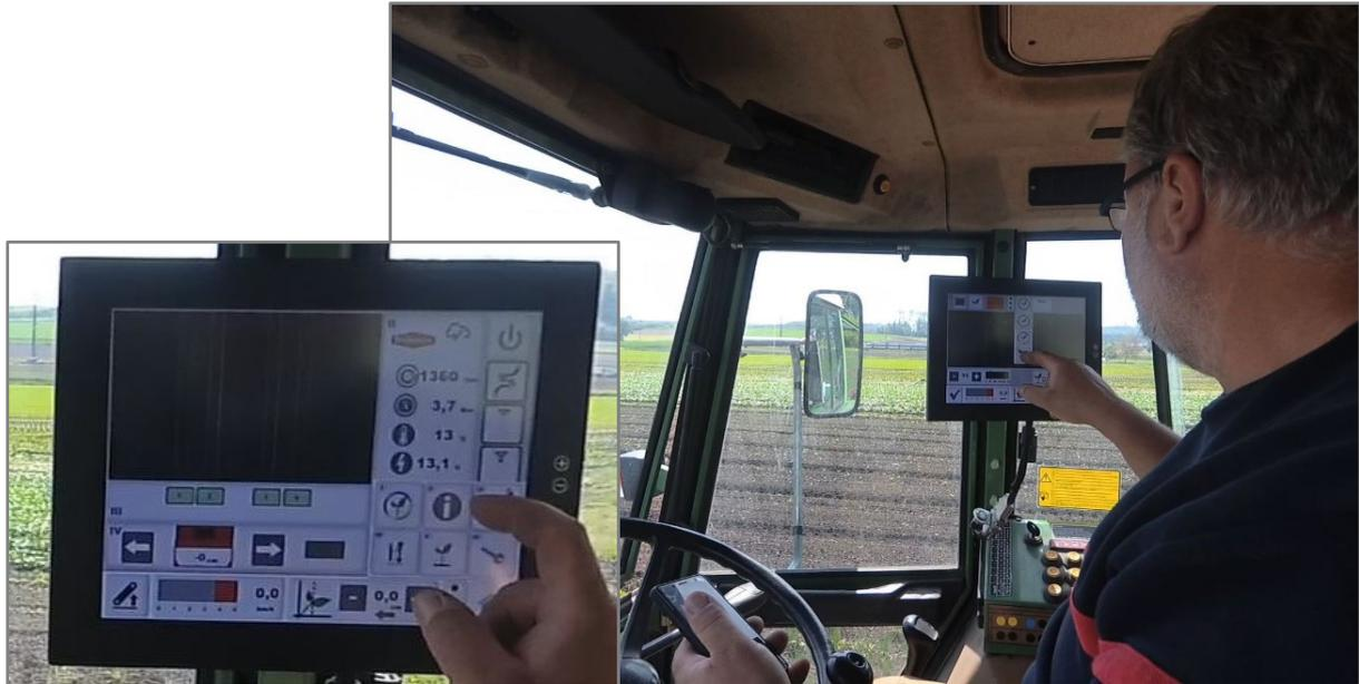
Abbildung 4: Das Display enthält neben dem Fenster für die Überwachung der Bildanalyse (hier schwarzer Bereich, kleines Bild) zahlreiche Bedienfunktionen, die mit Piktogrammen bezeichnet sind.
