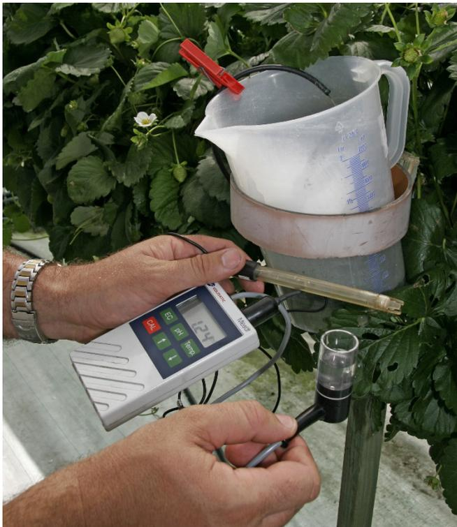
Abbildung 6. Kontrolle des pH- und des EC-Wertes des Nährlösungs.
