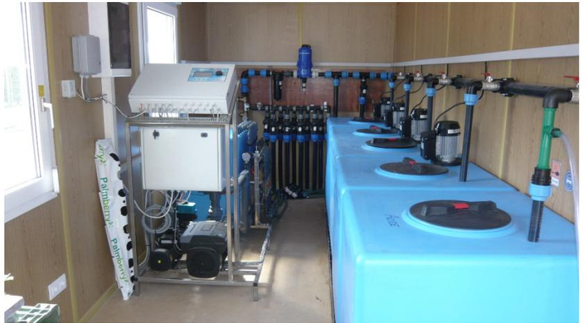
Abbildung 5. Automatische Mischanlage zur Herstellung der angepassten Nährlösung für Beeren auf Substrat.
