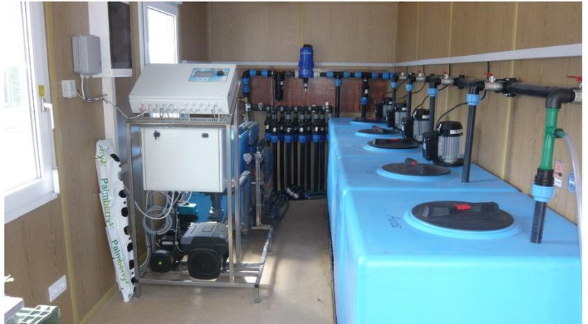
Figura 5. Installazione automatizzata per la preparazione della soluzione nutritiva destinata a piccoli frutti coltivati su substrato.
