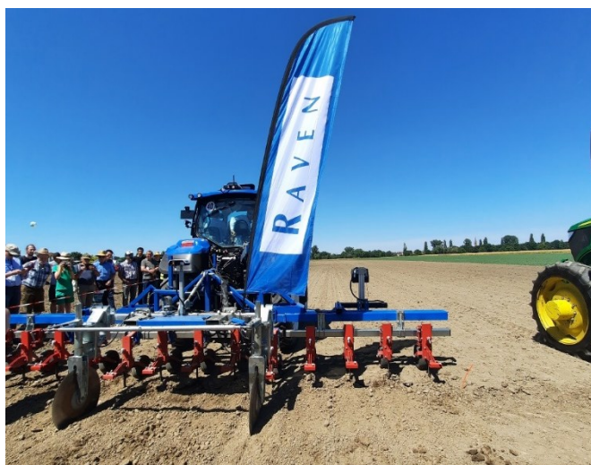
Immagine. 2: il sistema di guida con telecamera permette di seguire in modo preciso le file della coltura con la sarchiatrice della ditta Raven (foto: R. Total, Agroscope).
