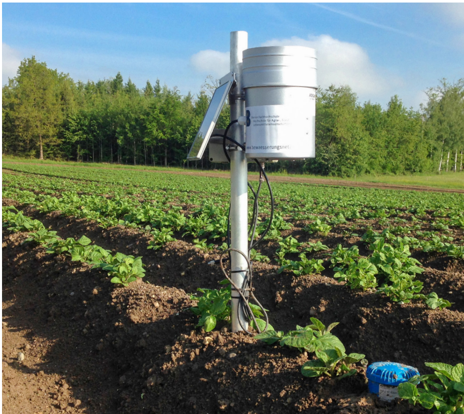
Les sondes d'irrigation aident à décider quand il faut commencer à irriguer. Grâce à elles, il est souvent possible d'attendre plus longtemps avant de le faire, et ainsi, d'économiser de l'eau.
