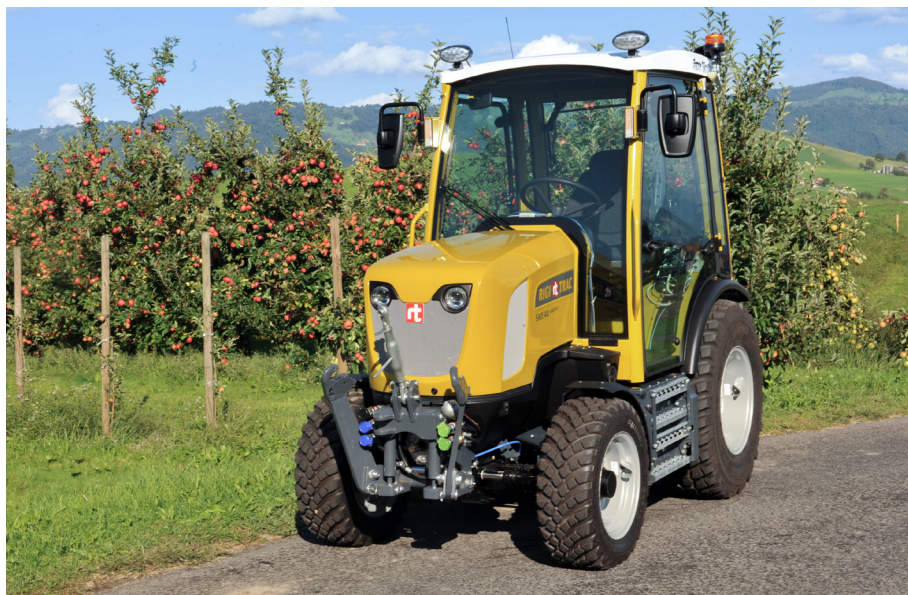
Pour préserver l'environnement et le porte-monnaie : le tracteur électrique Rigitrac SKE 40, très silencieux et sans émissions locales, limite les coûts d'énergie et de maintenance. Photo : Rigitrac Traktorenbau AG
