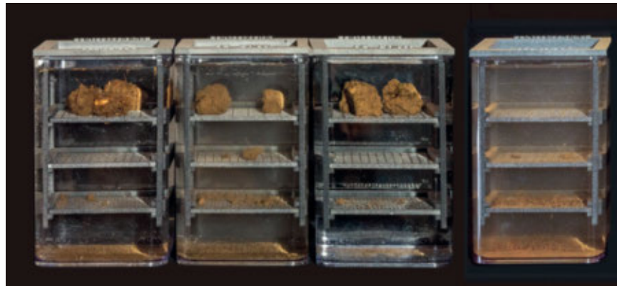
Test de stabilité des agrégats (de gauche à droite) : Frienisberg (BE), prairie (stabilité élevée), sol labouré nu (stabilité réduite) et culture dérobée en semis direct (stabilité élevée); sol labouré en Espagne (stabilité très faible).
