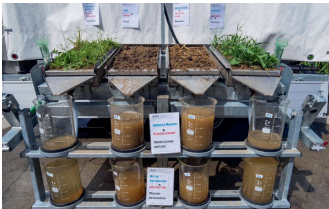
Simulateurs de pluie (types de sol de gauche à droite): (1) pâturage permanent, (2) sol nu après travail du sol, (3) semis sous litière, (4) sol avec semis direct sans travail du sol et culture dérobée de deux semaines.
