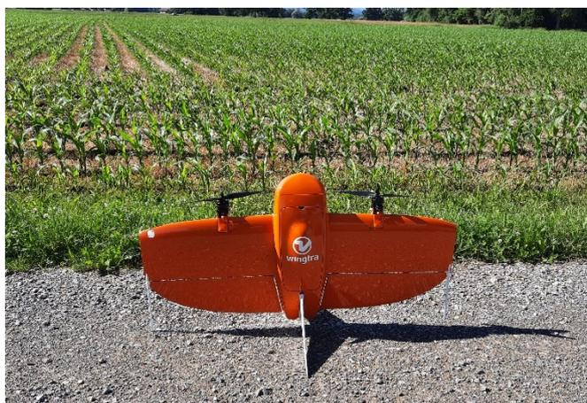
Abb. 1: Die grosse 'wingtra' startet senkrecht. In der Luft beträgt die Mindestgeschwindigkeit 50 km/h und die Flughöhe betrug 60 m (Foto: Agroscope).
