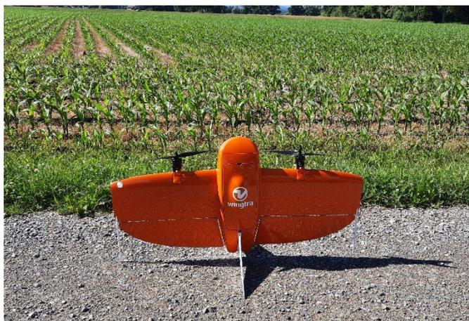
Foto 1: a grande 'wingtra' decolla in verticale. In volo la velocità minima è di 50 km/h e l'altezza di volo era di 60 m (foto: Agroscope).
