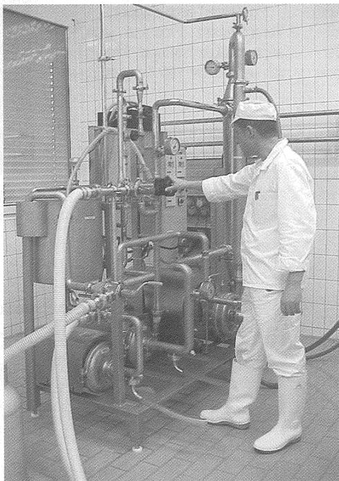
Abbildung 1: Die Milch wurde mit dieser Mikrofiltrationsanlage aufkonzentriert
