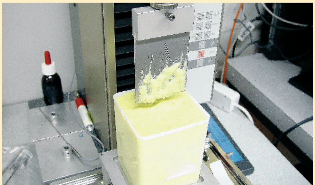
Abbildung 1: Messung der Textur von Kartoffelstock mit der modifizierten Warner-Bratzler-Prüfeinrichtung bei 56 °C (Beispiel Muster 1). Die Klebrigkeit wird durch die Arbeit beim Herausziehen der Schneide und durch das Zurückwägen der Schneide bestimmt
