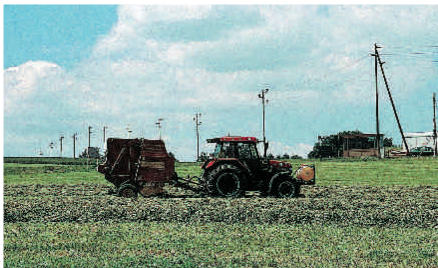
Fig. 9 et 10: Dans les presses à densité constante, l'humidité résiduelle s'échappe plus facilement que dans les balles conditionnées avec des densités de compression variables.
