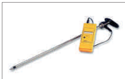
Fig. 2: Des instruments de mesure appropriés permettent de déterminer le taux d'humidité des balles directement sur le terrain.
