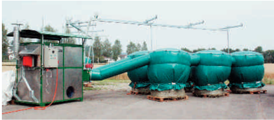
Fig. 4: L'installation de séchage Tecnolam pour balles rondes a demandé un investissement plus élevé, et consomme moins d'énergie.
