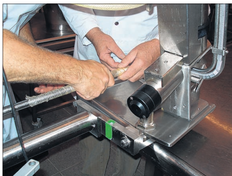
Mise en place des boyaux en fibres végétales marines sur le tuyau du poussoir.
