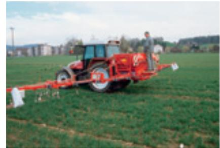
Abb. 3: Die Gülleausbringung (links) erfolgte mit einem Schleppschlauchverteiler, während ein pneumatischer Streuer den Mineraldünger streute (rechts).
