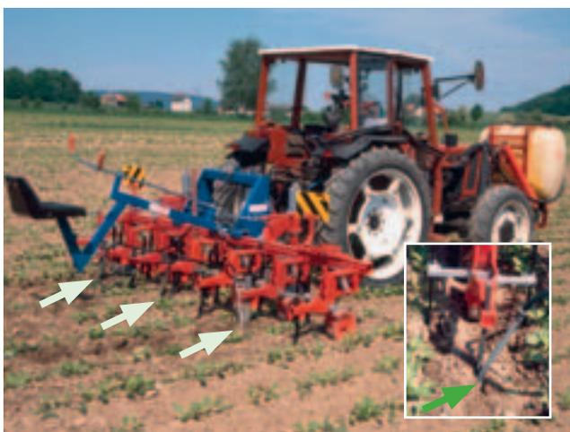
Abb. 11. Anlage der linienförmigen CULTAN-Depots zwischen jede zweite Pflanzenreihe in Kombination mit dem Hacken bei Zuckerrüben. In Kombination mit der Saat wurde durch bandförmiges Angiessen über jeder Reihe eine erste N-Startergabe appliziert.
