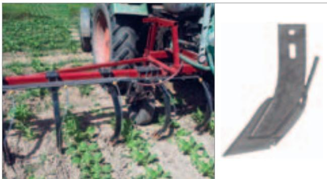
Abb. 2. Anlage eines CULTAN-Depots bei Reihenkulturen (Zuckerrüben) mittels Sechinjektoren (Betrieb M. Häberli, Rosshäusern BE). Die Dimensionierung von Flüssigkeitsbehälter, Pumpe, Leitungen und Injektoren richtet sich nach den angestrebten Düngemengen bzw. N-Konzentrationen.
