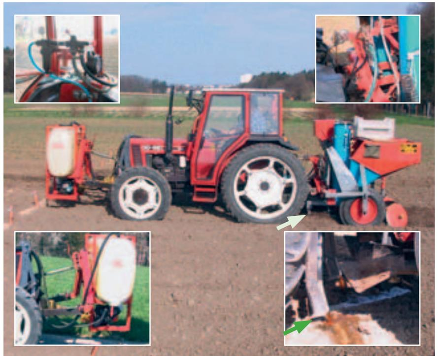
Abb. 10. Ausrüstung der zweireihigen Kartoffellegemaschine für die Linien-Injektion von Flüssigdüngern. Kleine Bilder: unten Flüssigkeitsbehälter mit Pumpe, Injektionsseche (Pfeil) vor dem Legeschar; oben Druckregelvorrichtung, Flüssigkeitsverteilung.
