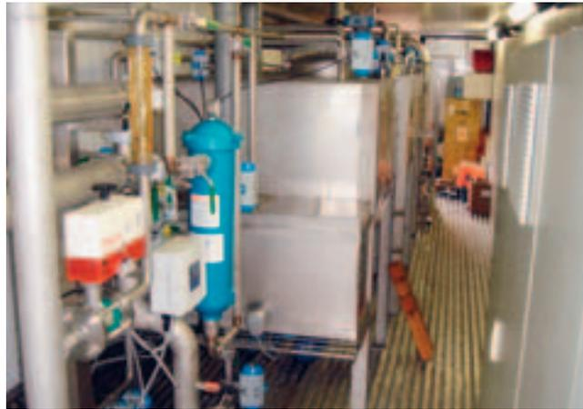
Abb. 8. Membrantrennanlage zur Aufbereitung der Gülle. Im Vordergrund ist die Umkehrosmose zu sehen. Diese Anlage ist in einem Container untergebracht und kann etwa 700 l Rohgülle pro Stunde behandeln.
