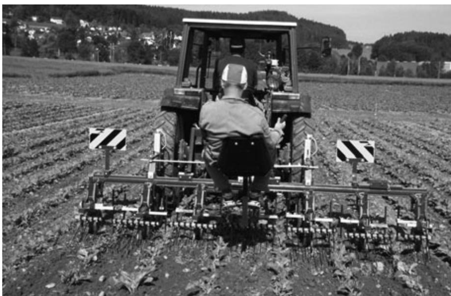
Abb. 1: Mit dreimaligen Einsätzen des Scharhackgerätes wurde eine ausreichende Unkrautregulierung zwischen den Reihen erzielt. Die angebauten Striegel verbessern den Arbeitseffekt wesentlich.
