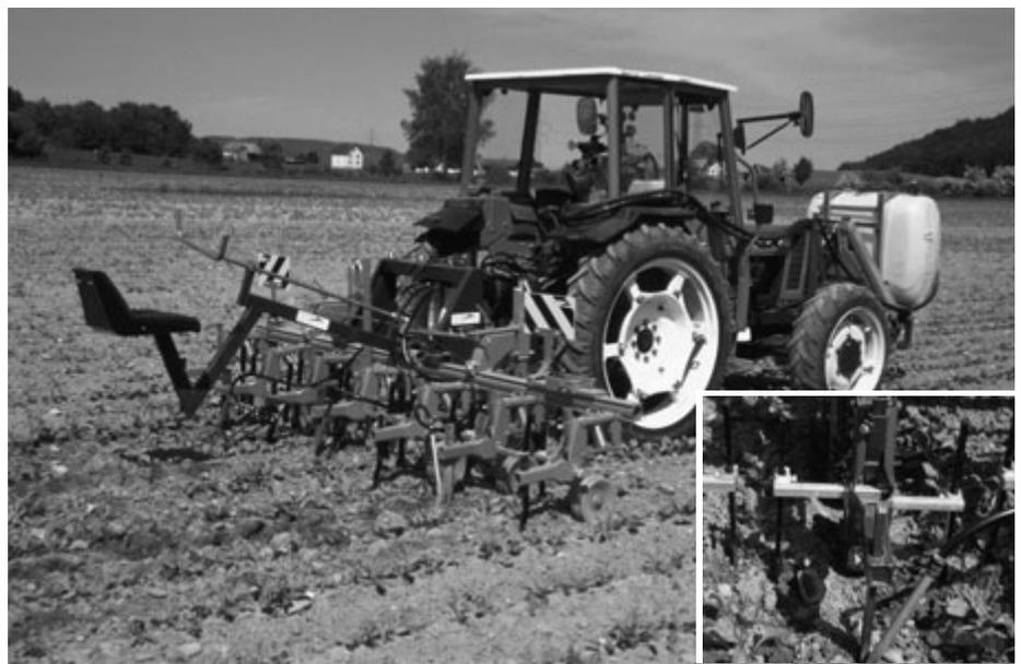
Abb.6: Bei der CULTAN-Düngung wird die konzentrierte Gülle von einer leistungs-fähigen Pumpe über Leitung, Armatur und Schläuchen zu den drei Lockerungsmei-seln geleitet und 15 cm tief zwischen den Rübenreihen abgelegt.
