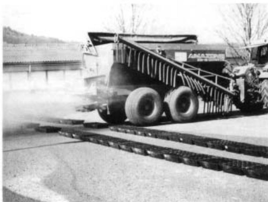
Fig. 4. Epandeur de grande capacité à l'action. Cet appareil a permis d'obtenir un épandage de bonne qualité. Il appartient en général à des entrepreneurs de travaux agricoles.
