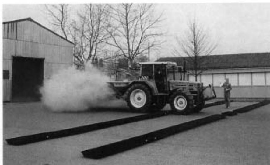
Fig. 1. Structure de l'essai pour évaluer la qualité de l'épandage. Le matériau épandu est collecté dans des coupelles, ce qui permet d'évaluer les quantités réparties. A droite du tracteur, on mesure également la teneur de l'air en poussière.
