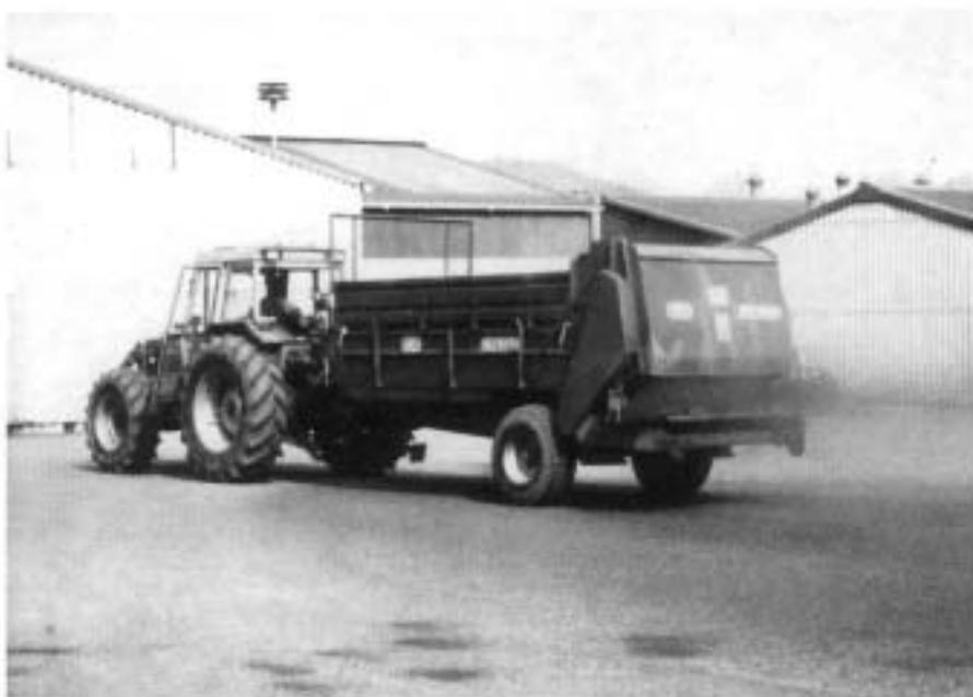
Fig. 5. L'épandeur de compost ne convient pas pour l'épandage des boues d'épuration étudiées. En outre, c'est avec cet appareil qu'on a relevé les émissions de poussière les plus importantes.
