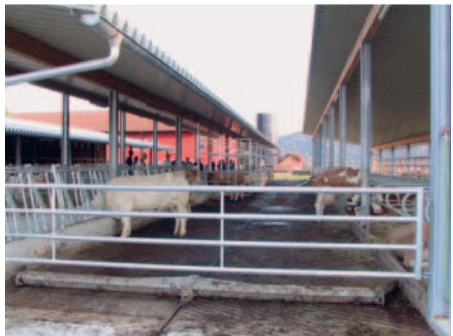
Fig. 12: Lorsque les axes d'évacuation sont droits, les racleurs fixes conviennent bien. Dans ce cas, il n'est pas nécessaire d'ouvrir, ni de fermer les portes et les séparations entre les différents groupes d'animaux.
