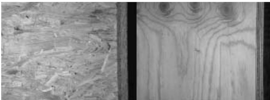
Abb. 2: Preislich interessant sind auch grossformatige Elemente, wie OSB- oder Seekiefer-Sperrholz-Platten, sofern man nicht die höchste Qualität beansprucht.
