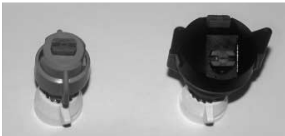
Fig. 3: Les buses à injection d'air, à jet plat, individuelles et doubles se caractérisent par des gouttes relativement grossières, peu sujettes à la dérive et par une importante plage de pression (Agrotop de U. Wyss, Bützberg).
