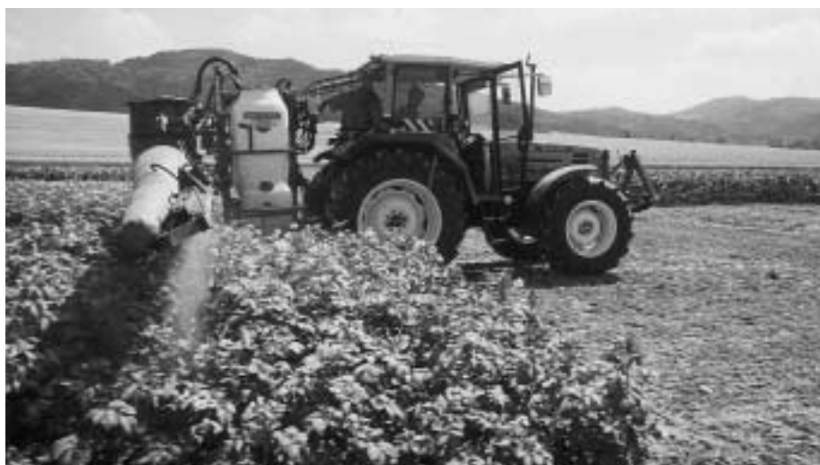
Fig. 2: L'assistance pneumatique améliore la pénétration du peuplement et réduit la dérive.
