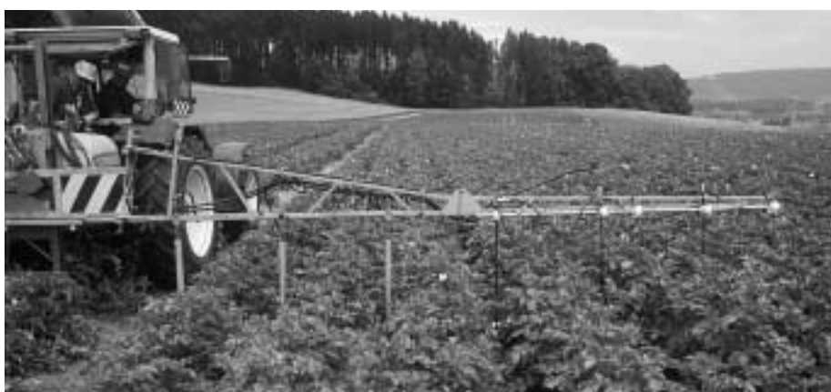
Fig. 1: Des pulvérisations ciblées, appliquées à temps depuis les voies de passage suffisent généralement à protéger les pommes de terre du mildiou. En bas: les meilleurs résultats ont été obtenus avec le dispositif de pulvérisation sous-foliaire (prototype).
