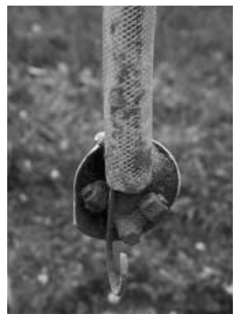
Fig. 6: Les supports de buses, suspendus sur ressorts sont réglables horizontalement et verticalement sur la perche du pulvérisateur (Fischer, prototype 2). A droite: le dispositif de protection de la buse, en forme de cône, s'est avéré satisfaisant, mais doit encore être amélioré.
