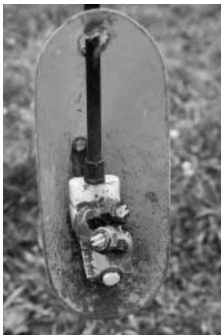
Fig. 7: Les supports de conduits en plastique relativement souples peuvent être réglés et fixés (Birchmeier, prototype 1). En bas: les buses doubles bien placées nécessitent une protection compacte et des supports plus stables.
