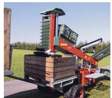
Abb. 17: Der Kistenfüller des Erntegeräts Pluk-o-trak ermöglicht eine gleichmässige Verteilung des Ernteguts in der Grosskiste.
