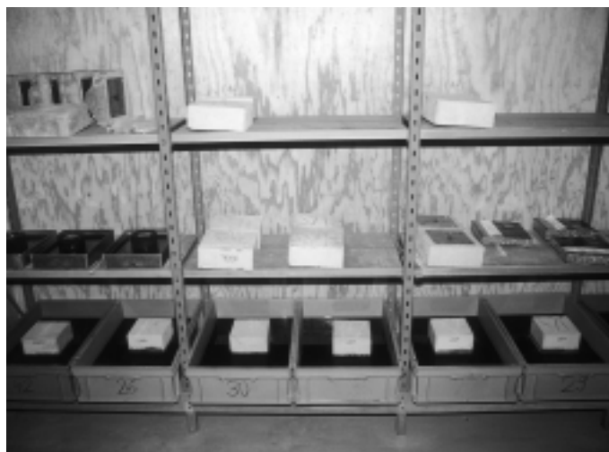
Fig. 3: Parallèlement à l'essai sur la machine, des échantillons de béton et d'asphalte ont été plongés en permanence dans le jus de fermentation.
