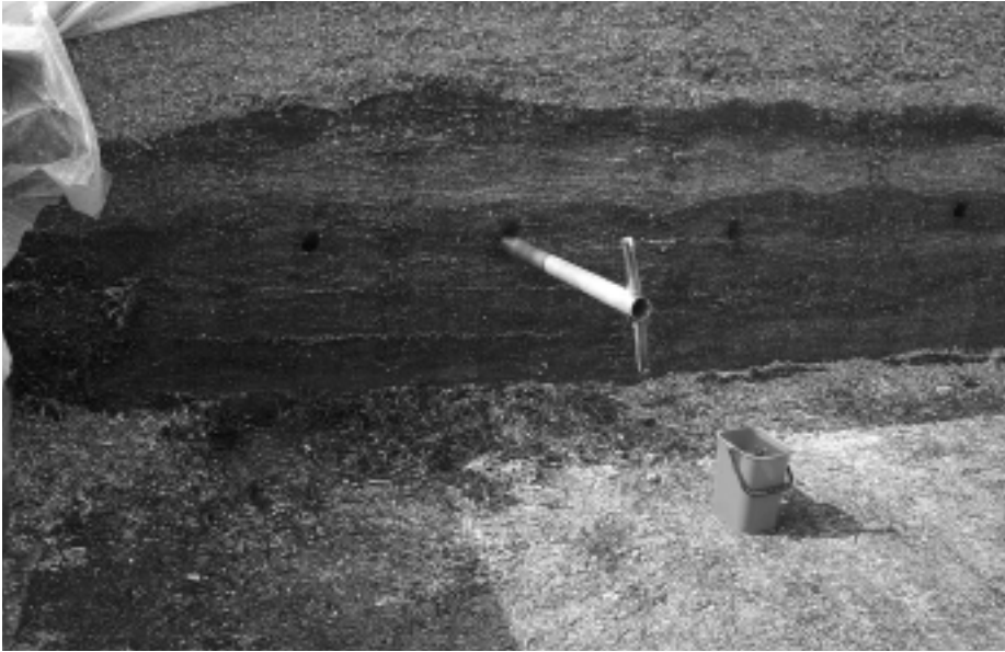
Fig. 4: Deux échantillons ont été prélevés dans chaque silo-couloir pourvu d'une dalle en béton bitumineux: un échantillon témoin (sans contact avec le sol) et un échantillon ayant été en contact direct avec le sol.
