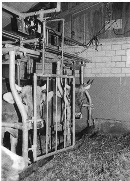
Photo 3. Lorsque la vache défèque ou urine, la crèche est fermée pneumatiquement. L'efficacité de ce système s'est avérée satisfaisante.
