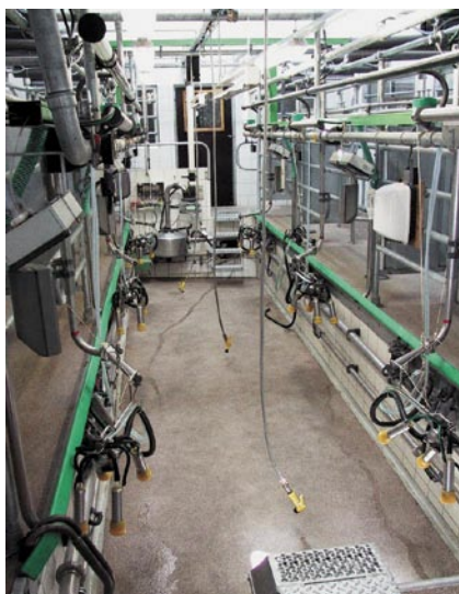
Abb. 12: Tandem-Melkstand mit 2x3 Melkplätzen, ausgerüstet unter anderem mit Terminals zur Milchmengenerfassung.
