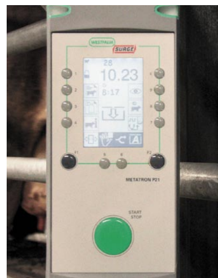
Abb. 12: Tandem-Melkstand mit 2x3 Melkplätzen, ausgerüstet unter anderem mit Terminals zur Milchmengenerfassung.
