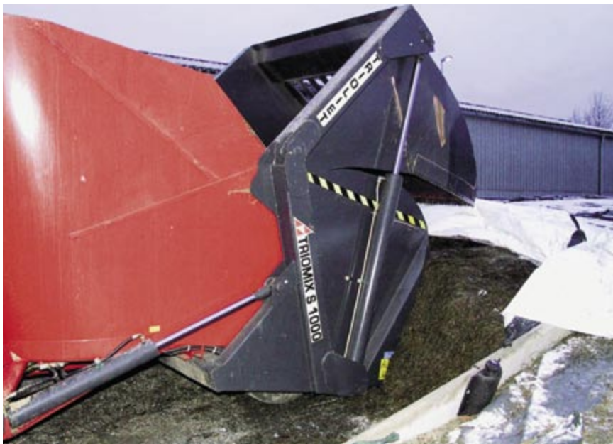
Fig. 3: Les auto-remplisseuses peuvent reprendre l'ensilage dans le silo-couloir à l'aide d'une fraise, d'une griffe de désilage ou comme sur la photo, à l'aide d'une lame de coupe.
