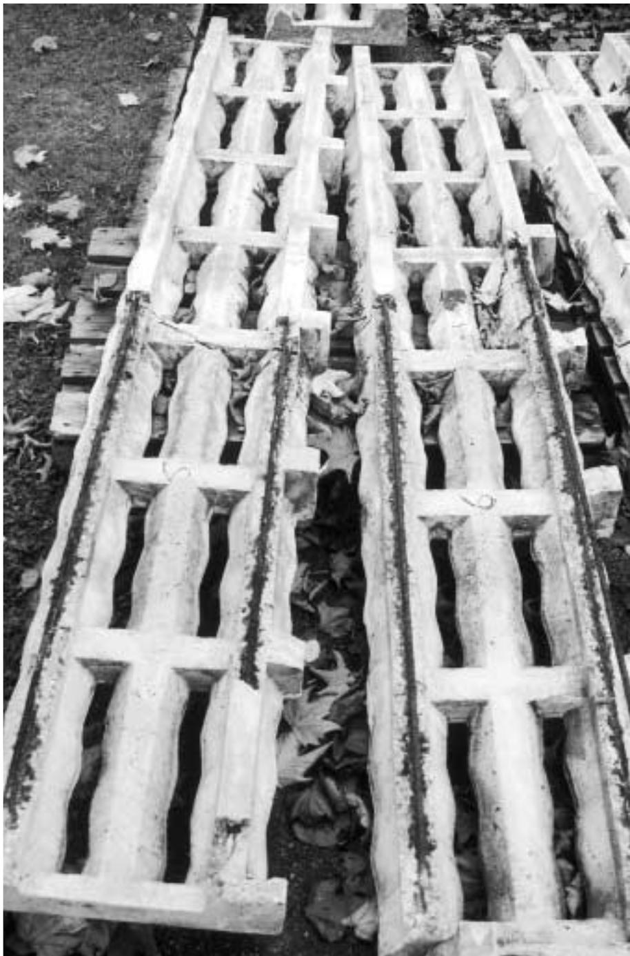
Abb. 15: Bei den Flächenrosten 5 (links) und 6 wurde der Armierungsstab in beiden Balken ausgerissen.
