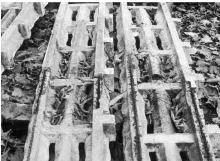
Abb. 10: Untenansicht der Elemente 18 (links) und 19 (rechts) nach dem Belastungsversuch. Bei beiden Elementen ist im linken Balken der Armierungsstab ausgerissen.
