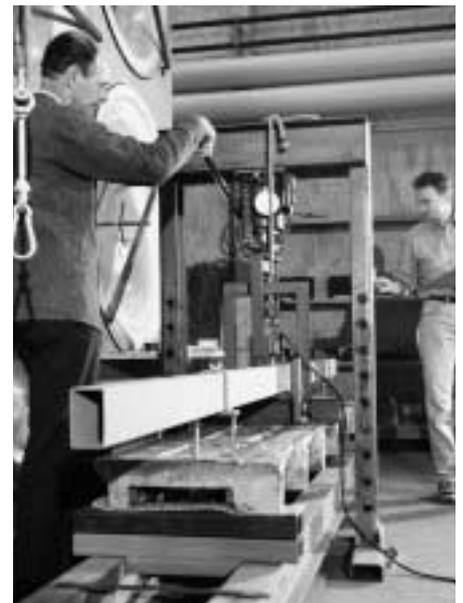
Abb. 8: Versuchsanlage für die Belastungsversuche an Betonflächenelementen.
