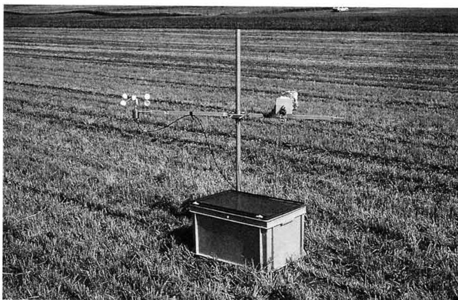
Fig. 3. Essais en plein champ proches de la pratique à échelle 1:1: Mesure continue de la concentration d'ammoniac et de la vitesse du vent à une hauteur donnée au-dessus du sol pendant 2 à 4 jours.
