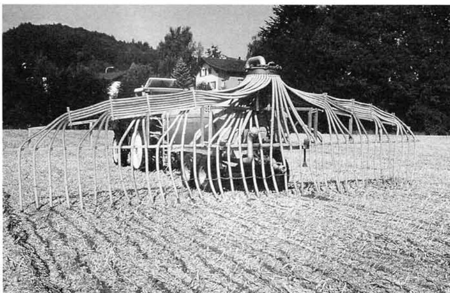
Fig. 14. Les épandeurs à tuyaux souples répandent le lisier en bandes, à proximité immédiate du sol. La surface de contact du lisier réduite induit des pertes d'ammoniac nettement plus faibles.
