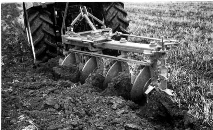
Abb. 5: Scheibenschwenkpflug (Galucho): Der Wendevorgang erfolgt ähnlich wie beim «Swing-Plow». Neigungseinstellung und Vorderfurchenbreite können nicht verstellt werden.
