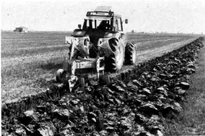
Abb. 14: Die Bildung von Pflugsohlen und die Unterbodenverdichtungen könnte mit «Offset-Pflügen» wesentlich vermindert werden. Es ist zu hoffen, dass in Zukunft dieser Entwicklung vermehrt Beachtung geschenkt wird (Photo Nardi).
