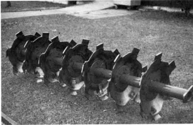
Abb. 13: Der Scheibenrotor (links) ist nicht für unsere Verhältnisse geeignet, weil damit nur in durchnässten Böden normal gefahren werden kann, was aus Gründen des Bodenschutzes unterlassen werden soll. Gut arbeitet der Spatenrotor (rechts).
