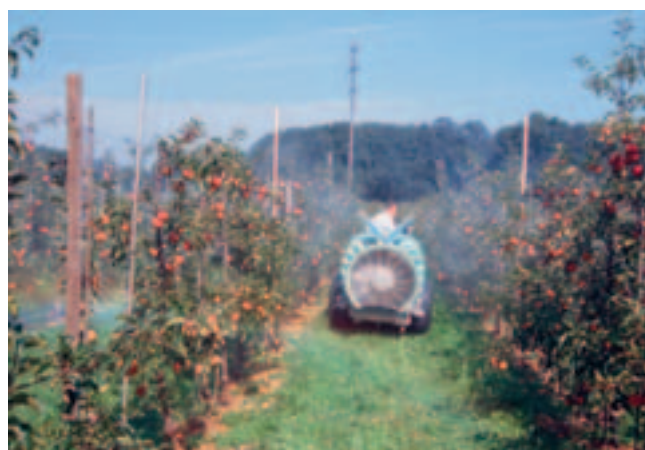
Abb. 4: Eine schmale Baumhecke erfordert eine entsprechend reduzierte Brühmenge/ha und Luftleistung. Axialgebläse ohne Aufsatz (Berthoud).
