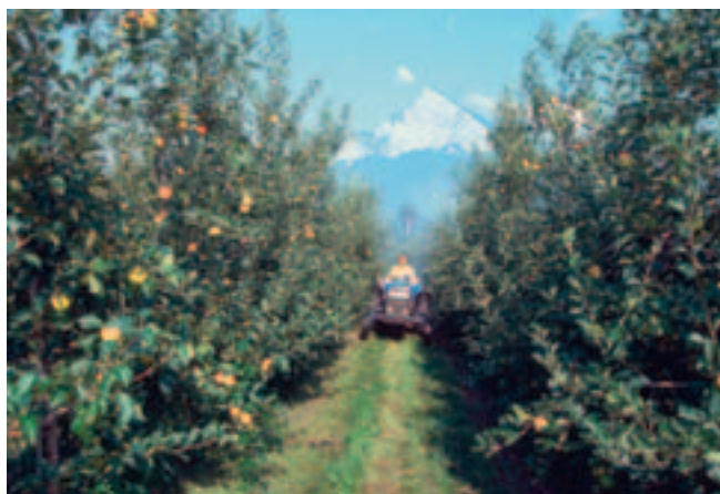
Abb. 2: Anlagen mit einem grossen Baumvolumen erfordern ein gutes Abstimmen der Luftleistung und der Fahrgeschwindigkeit. Dies ist durch eine manuelle stufenlose Schaufelwinkelverstellung möglich (Tifone).
