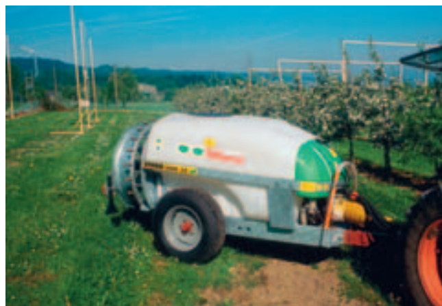
Abb. 2: Anlagen mit einem grossen Baumvolumen erfordern ein gutes Abstimmen der Luftleistung und der Fahrgeschwindigkeit. Dies ist durch eine manuelle stufenlose Schaufelwinkelverstellung möglich (Tifone).
