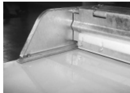
Abb. 34: Durch den vermehrten Einsatz von Betonoberflächen und das häufigere Entmisten wird der Einsatz einer Verschleisschicht bei Klapp- und Kombischiebern wieder aktueller.
