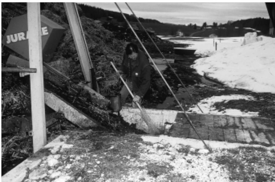
Abb. 17: Die Aussenbereiche der Entmistungsanlage müssen leicht zugänglich sein. Zur Vermeidung von Frostpannen ist oft ein Nachreinigen nötig.
