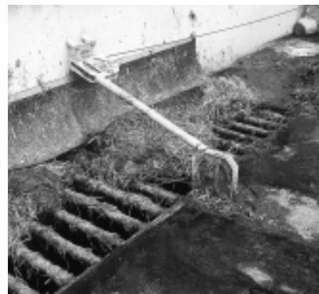
Abb. 12: Bei Rosten für Langstrohmist sollten die Stäbe wo möglich am Ende frei auslaufen.
