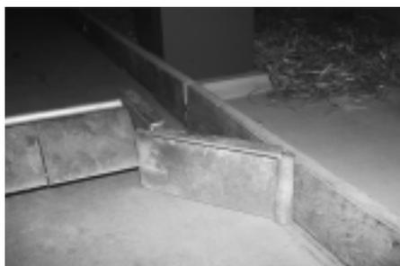
Abb. 15: Seitenflügel an Kombischiebern reinigen die Randpartien. Durch die beweglichen Flügel eignet sich der Schieber auch für Mistbahnen mit unregelmässiger Breite.
