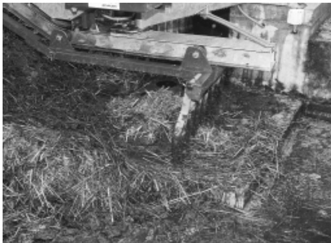
Abb. 22: Die Übergabestelle zum Hochförderer muss leicht zugänglich sein. Gegenüber dem Mistplatz erhöhte Podeste eignen sich dazu besser als mit grossem Aufwand erstellte Mulden.
