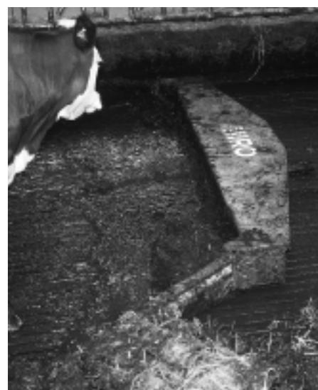
Abb. 35: Beim Entmistungsroboter entfallen Aussparungen für Antriebe und Umlenkungen. Dadurch ist er besonders flexibel einsetzbar. Die grösseren Bau-masse setzen besonders tiefe Arbeitsgeschwindigkeiten voraus, damit keine zusätzlichen Verletzungsgefahren entstehen.
