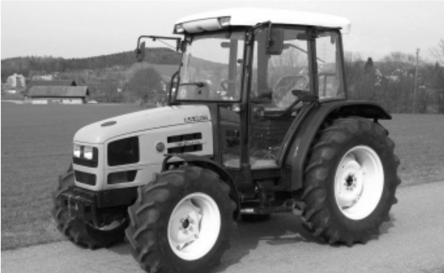
Abb. 10: Traktor HÜRLIMANN XA 656, 3-Zylinder-Turbomotor mit 46 kW (63 PS), 3-Stufen-Lastschaltgetriebe, Gewicht 2830 kg, (Listenpreis Fr. 61 200.-), Traktortest-Nr. 1809/00.
