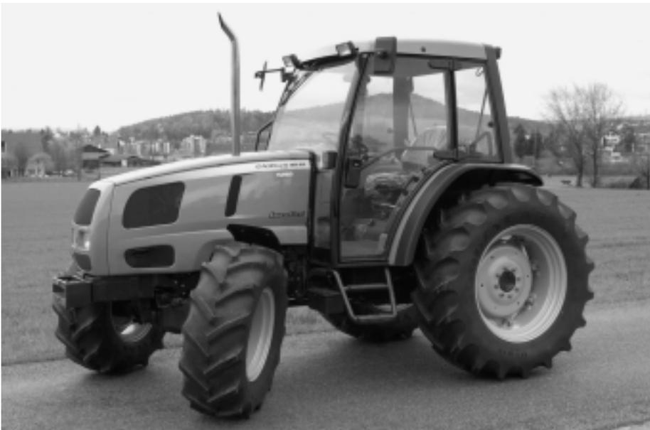
Abb. 11: Traktor LANDINI Globus 65 Turbo, 4-Zylinder-Turbomotor mit 55 kW (75 PS), 2-Stufen-Lastschaltgetriebe, Gewicht 2920 kg, (Listenpreis Fr. 61 200.-), Traktortest-Nr. 1811/00.
