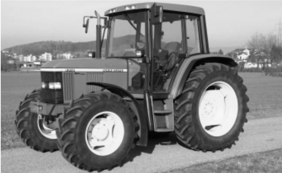
Abb. 7: Traktor JOHN DEERE 6310, 4-Zylinder-Turbomotor mit 74 kW (100 PS), 4-Stufen-Lastschaltgetriebe, Vorderachsfederung, Gewicht 4920 kg, (Listenpreis Fr. 102 685.-), Traktortest-Nr. 1801/00.
