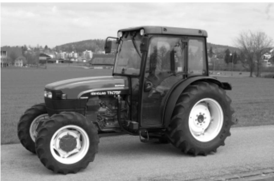
Abb. 12: Traktor NEW HOLLAND TN 75 F, 4-Zylinder-Saugmotor mit 56 kW (76 PS), 2-Stufen-Lastschaltgetriebe, Traktorvorderachse SuperSteer, Gewicht 2810 kg, (Listenpreis Fr. 71 800.-), Traktortest-Nr. 1812/00.
