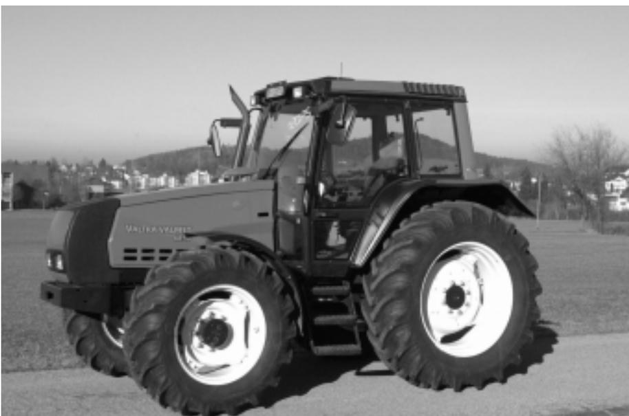
Abb. 6: Traktor VALMET 6850-4 HiTech, 4-Zylinder-Turbomotor mit Ladeluftkühlung, 88 kW (120 PS), 3-Stufen-Lastschaltgetriebe, Gewicht 4720 kg, (Listenpreis Fr. 96 900.-), Traktortest-Nr. 1800/00.
