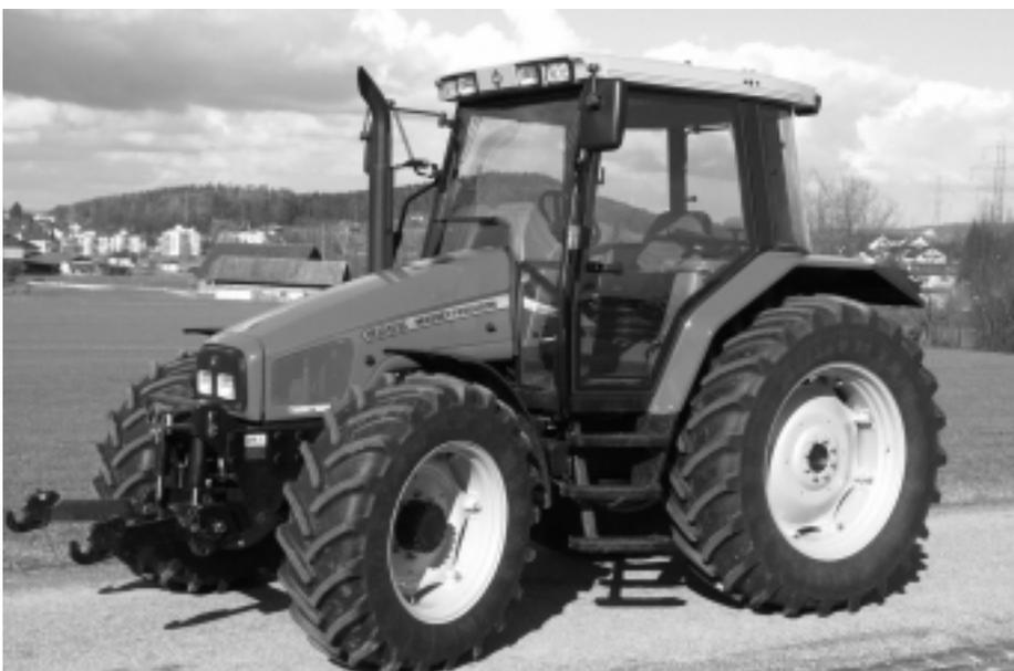
Abb. 9: Traktor MASSEY FERGUSON 6255, 4-Zylinder-Turbomotor mit 70 kW (95 PS), 4-Stufen-Lastschaltgetriebe, Fronthydraulik und Frontzapfwelle, Gewicht 4870 kg, (Listenpreis Fr. 106 425.-), Traktortest-Nr. 1803/00.
