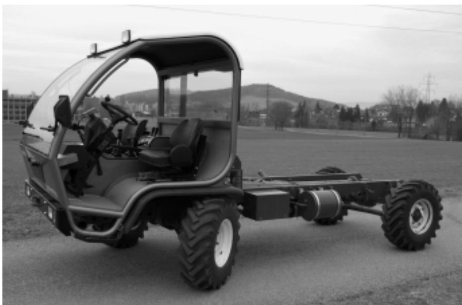
Abb. 1: Transporter SCHILTRAC 2068 (Version 40 km/h), 4-Zylinder-Turbomotor mit 61 kW (83 PS), 2-Stufen-Lastschaltgetriebe, Leergewicht 2180 kg, zulässiges Gesamtgewicht 7000 kg, (Listenpreis Fr. 78 200.-), FAT-Transportertest-Nr. 1797/00. Die Prüfverfahren der technischen Prüfung in der Schweiz und Österreich wurden angeglichen. Die Resultate sind somit grenzüberschreitend austauschbar.
