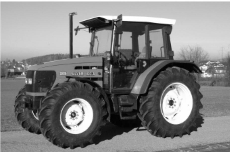
Abb. 5: Traktor SAME Silver 100.4, 4-Zylinder-Turbomotor mit Ladeluftkühlung, 74 kW (100 PS), 3-Stufen-Lastschaltgetriebe, Gewicht 4250 kg, (Listenpreis Fr. 86 100.-), Traktortest-Nr. 1799/00.
