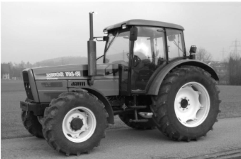
Abb. 8: Traktor ZETOR 116 41, 6-Zylinder-Saugmotor mit 81 kW (110 PS), 3-Stufen-Lastschaltgetriebe, Gewicht 4610 kg, (Listenpreis Fr. 95 138.-), Traktortest-Nr. 1802/00.
