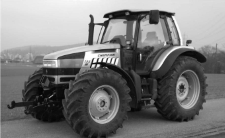
Abb. 4: Traktor LAMBORGHINI Champion 135, 6-Zylinder-Turbomotor mit 3-Ventiltechnik, 99 kW (135 PS) Getriebe mit 18 Lastschaltstufen in zwei Gruppen, Fronthydraulik und Frontzapfwelle, Gewicht 7200 kg, (Listenpreis 137 900.-), Traktortest-Nr. 1798/00.
