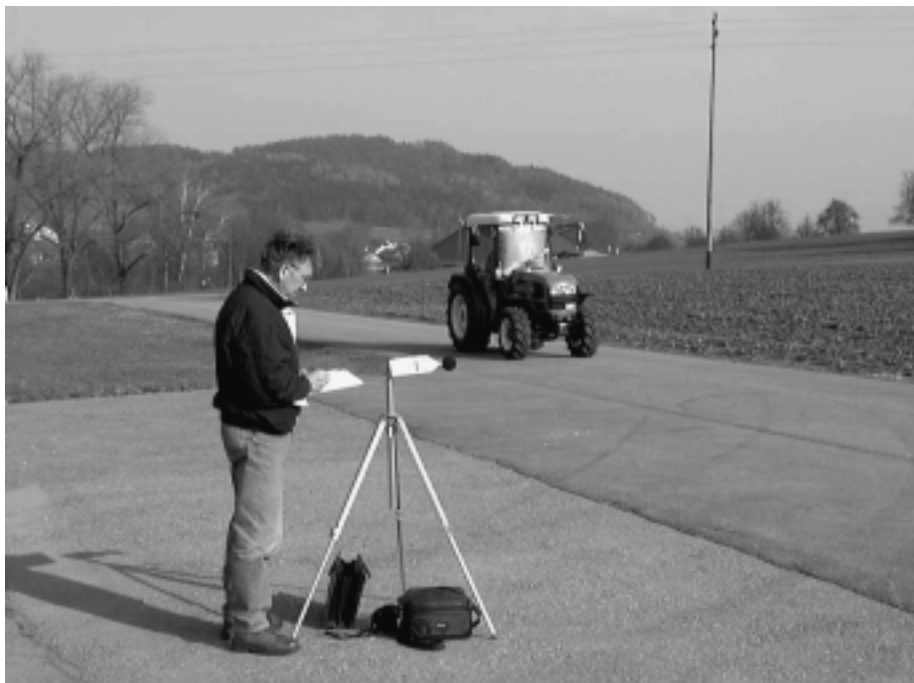
Abb. 3: Die Landwirtschaftstraktoren sind oft schon am frühen Morgen oder noch spät abends im Einsatz und sollten nicht durch übermässigen Lärm auffallen. Die Vorbeifahrtmessung erfolgt auf beiden Seiten des Traktors in einem Abstand von 7,5 Meter. Im Testbericht erscheint der höhere der beiden Messwerte.
