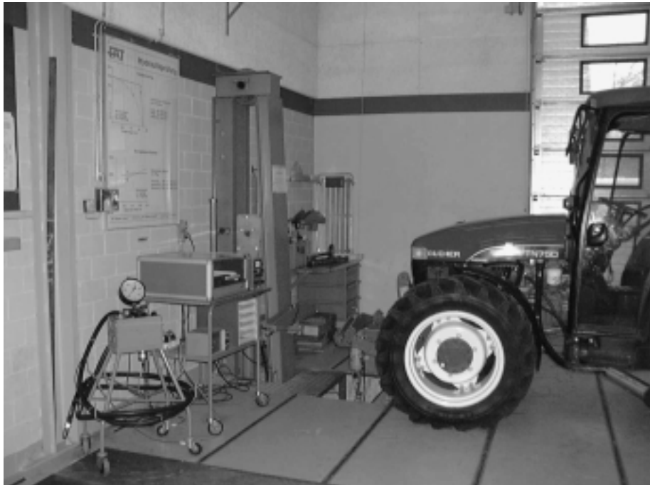
Abb. 5: Hubkraft der Hydraulik: Der Prüfstand erlaubt die Messung der Hubkraft über den ganzen Hubbereich, von ganz unten bis ganz oben. Im Testbericht erscheint jener Wert, der über den ganzen Hubbereich erbracht wird.
