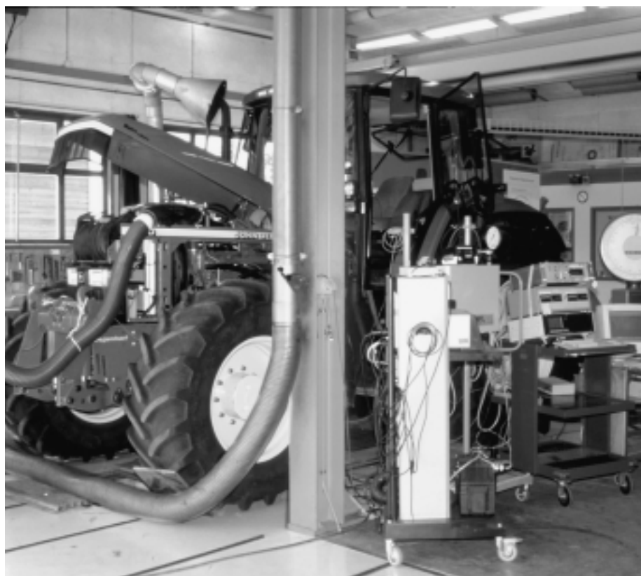
Abb. 1: Die Zapfwellenleistung, der Treibstoffverbrauch und die ausgestossenen Motorabgase sind wichtige Vergleichsgrössen beim Traktor. Ein Prüfstand, ausgerüstet mit modernsten Messgeräten sowie elektronischer Datenverarbeitung ermöglichen speditives Arbeiten und sofortige Auswertung der Resultate.
