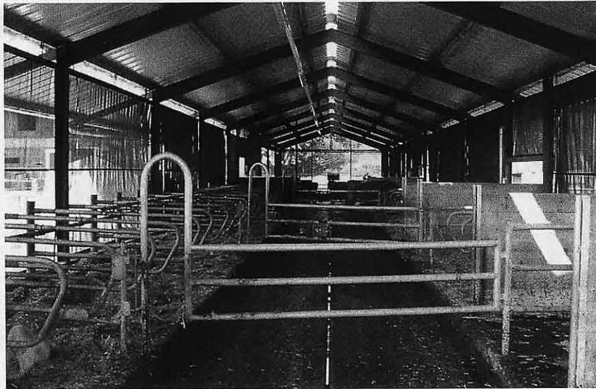
Abb. 12. Wenn die ganze Umwandung des Stalles mit Windschutznetz ausgebildet wird, muss ein Netz mit hohem Luftwiderstand und guter Bremswirkung gewählt werden.
